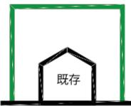
既存建屋内の工場が稼働している状態で外側に新規のフレームを被せるように構築。
